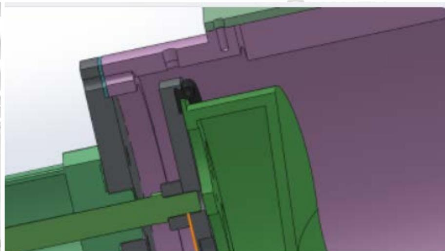
**Выпускной клапан высокого смесителя использует двойное цилиндрическое управление, а полость выпускного клапана в литой алюминиевой форме увеличивается (диаметр 300), чтобы обеспечить быстрое время выгрузки, и каждый из них открывается и закрывается на месте.**
